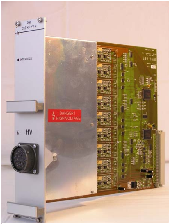
Fig. 5. HV power supply module.
