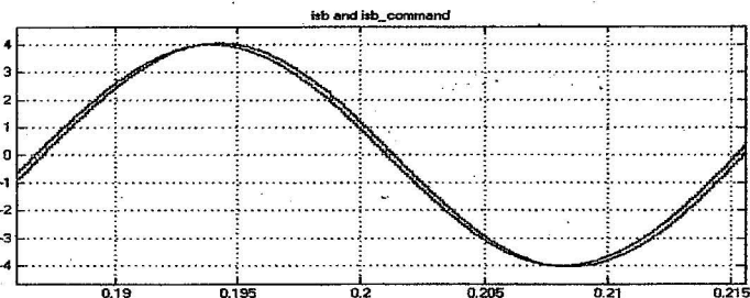
Фиг.4. Зададена и действителна стойност на \beta компонентата на вектора статорния ток
