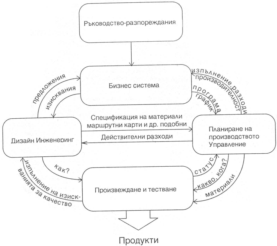
Фиг. 2 Информационна система в помощ на ръководството и управлението на електронното производство
