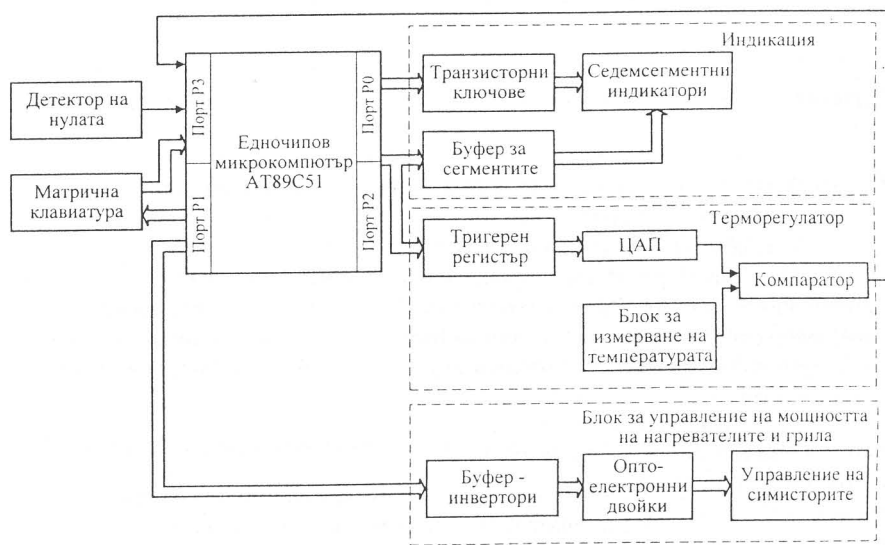
Фиг. 1. Блокова схема на програмируемия контролер за електро- домакинска печка
