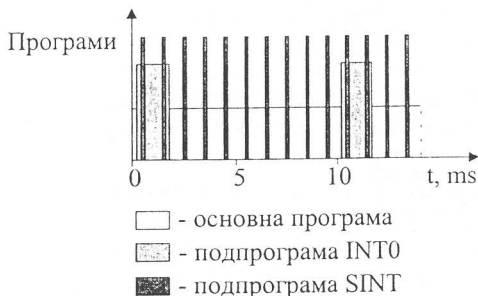
Фиг. 4. Времедиаграма на обработване на заявките за прекъсване
